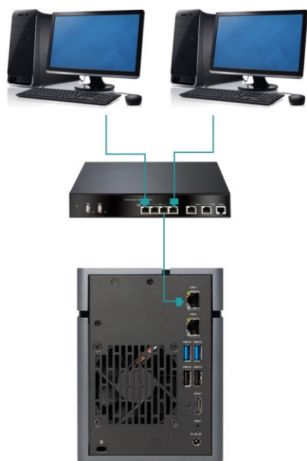
a. 连接一条网络线至多台主机
